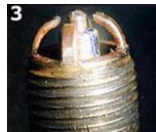
3 – боковые электроды WR 78 SUPER 4 (BOSCH) не затевают искру от камеры сгорания, но между электродами ее нет
