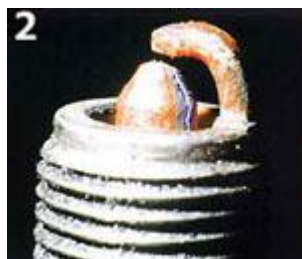
2 – свечи WR 7 DP PLATINUM (BOSCH), платиновый электрод так же бессилен, как и стандартный
