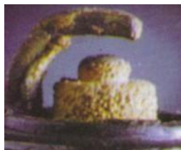
Рисунок 13 – Отложение свинца на свече зажигания
