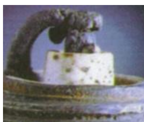
Рисунок 15 – Свеча при калильном зажигании
