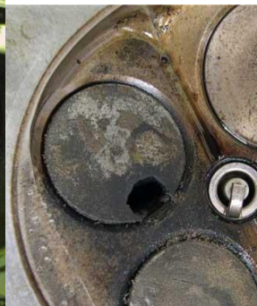
Клапан, поврежденный детонацией
