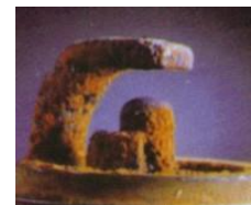
Свеча зажигания, поврежденная детонацией
