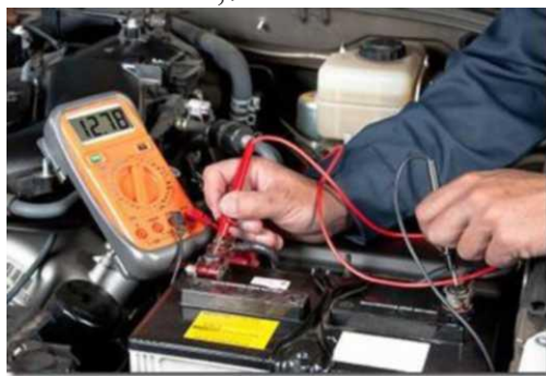
Рис. 3. Проверка напряжения аккумуляторной батареи
