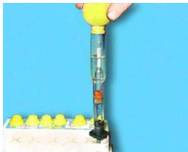
Рис. 2. Проверка плотности электролита ареометром
