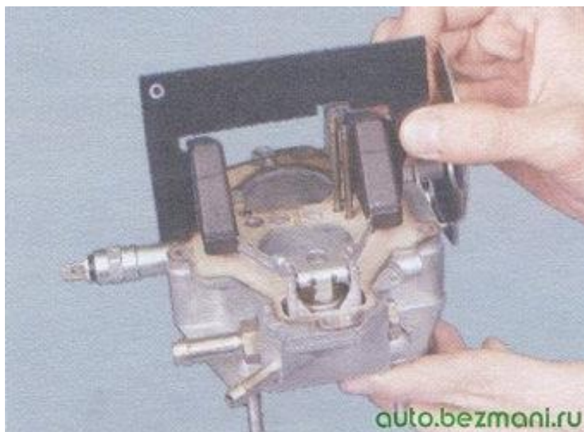
Рис. 4.13. Шаблон для регулировки положения поплавков карбюратора
